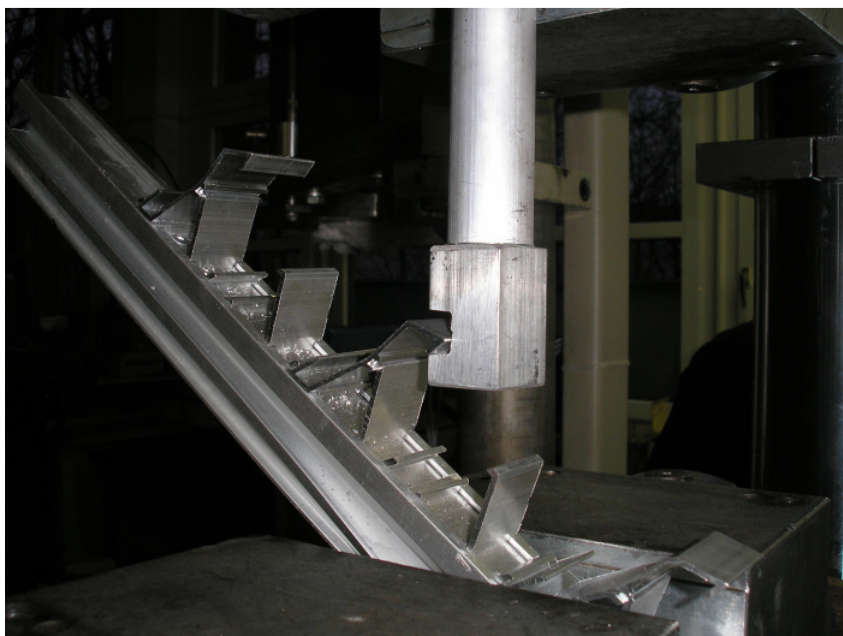
Bild 13: Prüfobjekt 020.2 bei der Belastungsprüfung (Schrägzug 45°)
